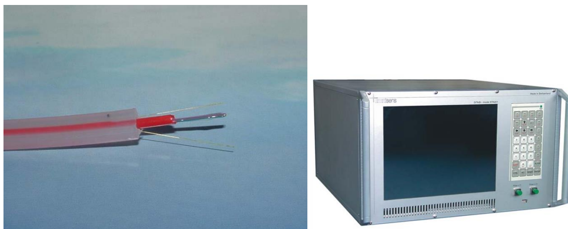
Figur 15 Fiberoptisk mätutrustning och avläsningsenhet DiTeSt från Smartec.
