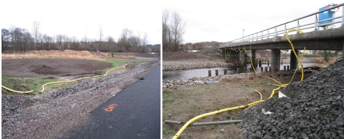
Figur 16 Extensometer och fiberoptisk mätutrustning monteras samman på vägbank väster om bron.
